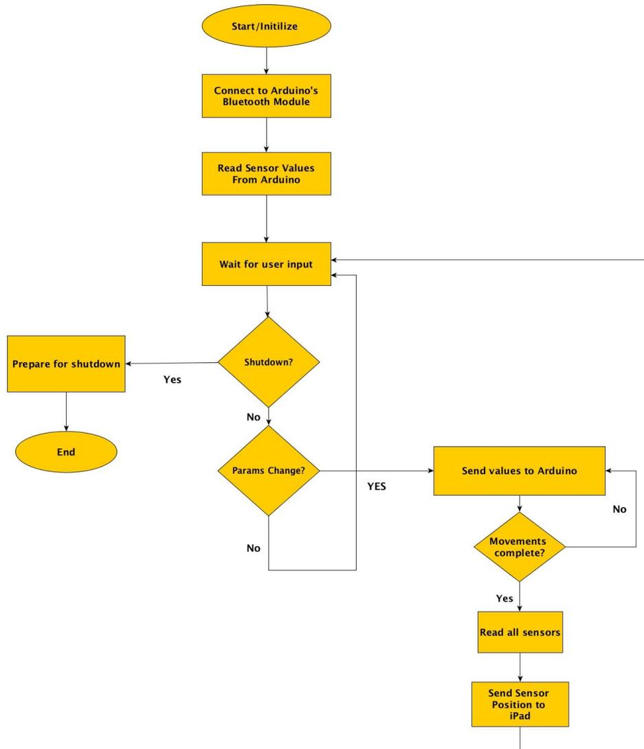
Figure 6.3-System Control Flowchart
